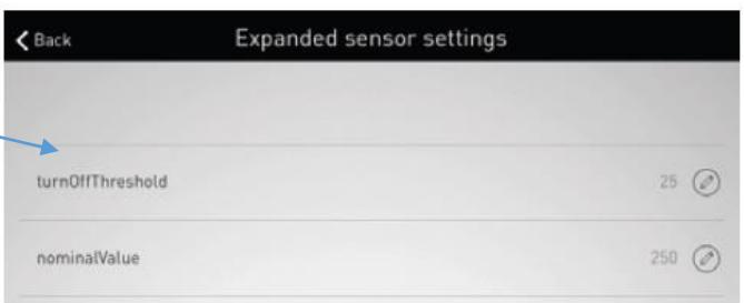
После нажатие на функцию сенсора, значения могут быть изменены и сохранены. Различные функции датчика описаны в таблице ниже.
